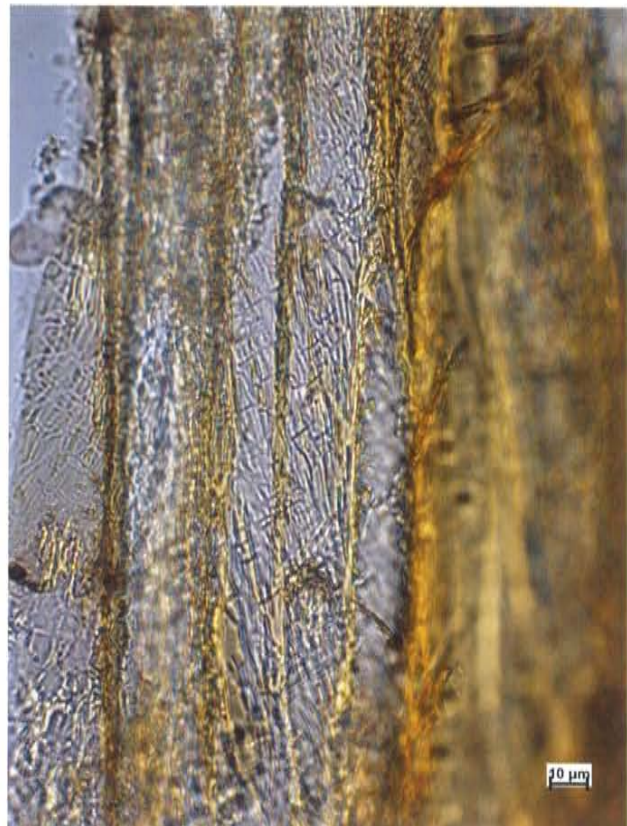
Abb. 2: Prüfkörper 1; Thermisch modifizierte Yellow Poplar (Cambia), Kavernen von Moderfäulepilzen, M 600:1
