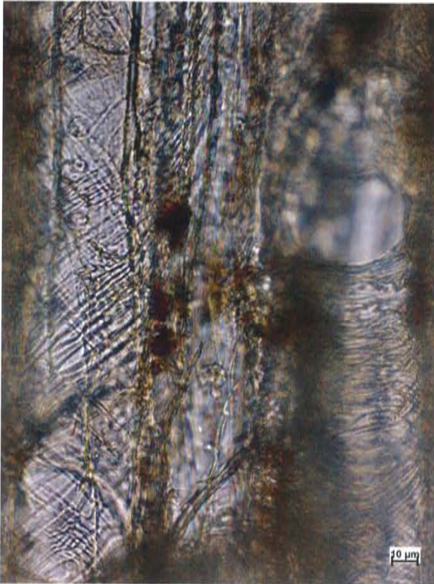
Abb 1: Prüfkörper B31; Rotbuche, Kavernen von Moderfäulepilzen, M 600:1
